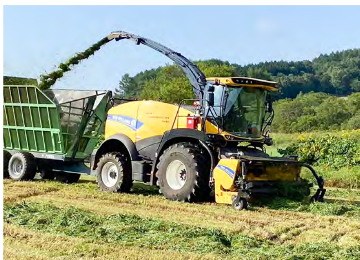
作業機械「自走式ハーベスター」の作業風景
